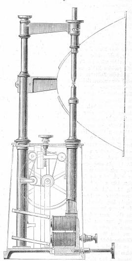
nicht mehr abrollen; der daran aufgehängte Kohlenhalter muss also der aufsteigenden Bewegung des Ankers folgen, bis die Reaction der Feder W mit der senkrechten Componente der magnetischen Anziehung des Ankers im Gleichgewicht ist. Auf diese Weise bildet sich der Lichtbogen.
