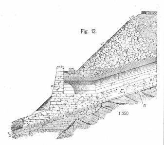
durchfahrene Gestein war zwar fast überall fest, erforderte aber wegen der zahlreichen Klüftungen eine leichte Verkleidung und es ist in Folge dessen die Type  $1^{c'}$  zumeist in Ausführung gekommen. Die Ausmauerung besteht aus Bruchsteinmauerwerk und ist im Scheitel  $0,4\ m$  und im Widerlager  $0,5\ m$  stark. Das Mauerwerk ist dicht an das Gebirge angesetzt.
