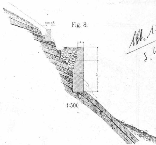
Mauern die Grenzen sehr enge gesteckt, weil das zumeist sehr abschüssige Terrain zur Vermeidung zu grosser Mauerhöhen einen steileren Anzug verlangte. In der Regel sollten die Stützmauern mit einer Dossirung von 1/5 angelegt werden; es zeigte sich aber in sehr vielen Fällen vortheilhafter, dieselben sogar vertical zu machen, und in der That sind an der Gotthardbahn mehr, als es sonst im Bahnbau üblich ist, solche Mauern ausgeführt. (Vergl. Fig. 8.)
