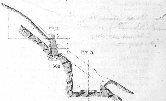
Die normale Bahnbreite in der Schienenhöhe beträgt 4 m auf der Thalbahn, 4,20 m auf der Bergbahn. Die Unterbaubreite ist 5,20 m auf der Thalbahn und 5,40 m auf der Bergstrecke. Die Tiefe der Bahngräben ist 0,70 m bei einer normalen Breite von
