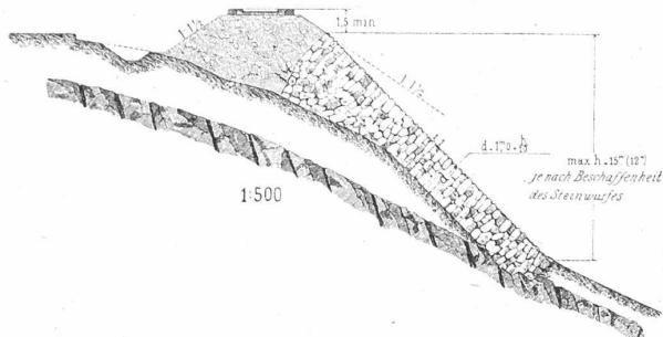
Im Allgemeinen ist bei den Erdarbeiten Materialausgleich zwischen Ab- und Auftrag erzielt. Wo dies nicht möglich war, wurden bei Materialmangel zunächst die Einschnitte ausgeschlitzt oder das Material womöglich dort gewonnen, wo dadurch ein erhöhter Schutz gegen Ueberflutung oder Ueberschüttung durch die Wildwasser oder gegen Steinschlag erzielt werden konnte.
