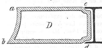
Wenn nun der Mörtel in den Fugen ab und cd zerdrückt ist und der Ziegel bei d aufsitzt und die Drehung um d erfolgen will, so beschreibt a einen Kreisbogen um d, welcher innerhalb der Schlusssteinfläche fällt. Es wird also der Ziegel in a und d auf Abscheerung beansprucht und es kann somit der Einsturz erst erfolgen, nachdem der Ziegel zerstört ist und vorangehend sehr sichtbare Deformationen eingetreten sind.
