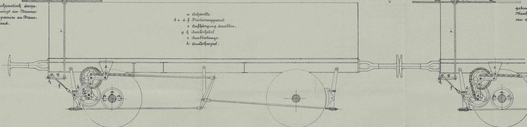
Schematische Darstellung eines mit Heberleinbremse versehenen Güterzuges. 1/200 nat. Größe.
