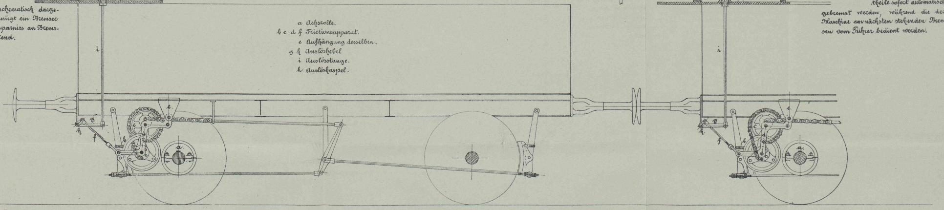
Schematische Darstellung eines mit Heberleinbremse versehenen Güterzuges. 1/200 nat. Größe.
