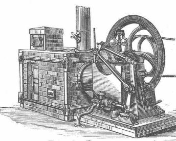
Erzeugt zum billigsten Preise dienöthige Triebkraft für Industrien, welche mit kleinen Motoren arbeiten. 25 kg Coaks per Tag und per Pferdekraft.
