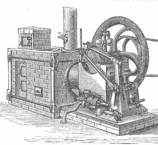
Erzeugt zum billigsten Preise dienöthige Triebkraft für Industrien, welche mit kleinen Motoren arbeiten. 25 kg Coaks per Tag und per Pferdekraft.
