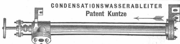
Vollkommenster und billigster Apparat für Dampfleitungen zur Verhinderung der Dampfentweichung, Abführung des Condensationswassers und Regulirung der Luft. — Garantie. — Beschreibung und Preise gratis. — Wiederverkäufer Rabatt.
