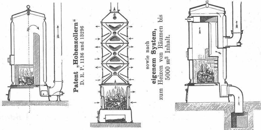
Erstere Oefen werden auch mit *Füll-Regulir-Vorrichtung* geliefert. Oefen meines neuen Systems können mit *Luft-Circulations-Einrichtung* versehen werden und dienen dann zur Erwärmung von *Trocken-Räumen*. Specielle Prospekte.
