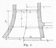
Das Integral des ersten Gliedes der Gleichung 3 ist nun einfach das Gewicht des im Rade befindlichen Wassers. Bezeichnet r den mittleren Radius des Kranzes,  $\gamma=1000$  das specifische Gewicht des Wassers, so ist nach der Guldinschen Regel sofort:
