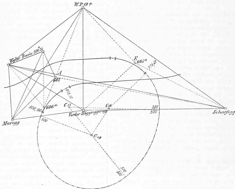
280 m, 500 m, 300 m, 280 m Radius und einer an letztere Curve sich anschliessenden Geraden gebildet ist, hat von dem Eingangsportal des Kehrtunnels bis zu dem Punkte, wo die obere rückkehrende Linie die untere überschneidet, eine Länge von 2130 m, und es beträgt bei einer Bahnsteigung von 23 ‰ im Tunnel und 26 ‰ auf der offenen Bahn, die durch diese Entwicklung gewonnene Höhe 51 m.
