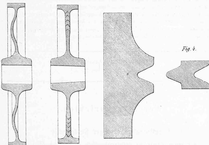
Durch das System des Wickelns, wobei die Faser des Eisens in der Richtung des Radumfangs liegt, ist es befähigt, der grössten Beanspruchung im Betriebe auf die Dauer zu widerstehen, zumal dasselbe in noch völlig glühendem Zustande aus dem Gesenke kommt und bei gewellter Form der Scheibe die Concretion bei dem Erkalten gleichmässig eintreten und keine schädliche Faserspannung bewirken kann, während bei allen Speichenrädern, trotz des Glühens, diese manchmal ganz bedeutend ist.
