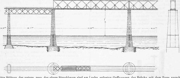
aufrechte Stützen, der untere, resp. der obere Streckbaum sind am Kreuzungspunkt der Streben aufgehängt, resp. gestützt. Die Höhe des Fachwerkes ist 1/s der Spannweite. Der obere und untere Streckbaum haben kastenförmigen Querschnitt, die Streben sind aus T-Eisen und die Zugbänder flach.
