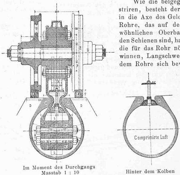
Wie die beigegebenen Zeichnungen illustrieren, besteht der „*Ascenseur*“ aus einem in die Axe des Geleises gelegten gusseisernen Rohre, das auf den Querschwellen des gewöhnlichen Oberbaues befestigt ist. Unter den Schienen sind, haupsächlich zu dem Zwecke die für das Rohr nötige lichte Höhe zu gewinnen, Langschwellen angeordnet. Der in dem Rohre sich bewegende Kolben trägt eine
