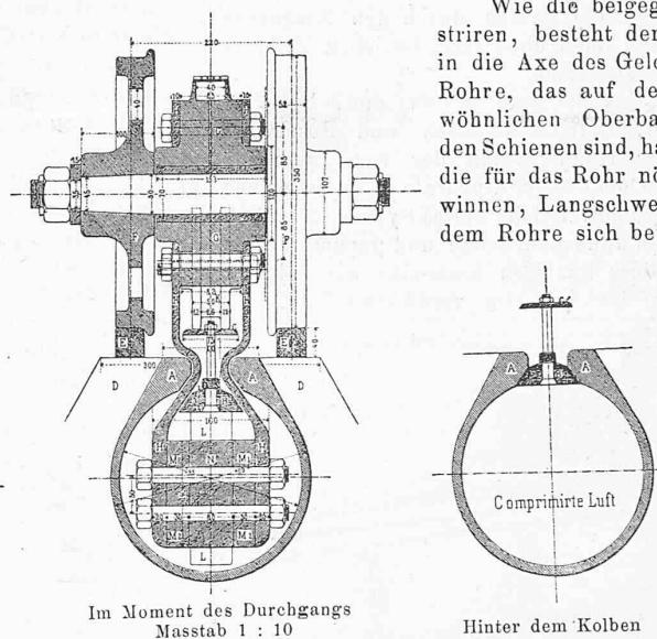
Wie die beigegebenen Zeichnungen illustrieren, besteht der „*Ascenseur*“ aus einem in die Axe des Gleises gelegten gusseisernen Rohre, das auf den Querschwellen des gewöhnlichen Oberbaues befestigt ist. Unter den Schienen sind, haupsächlich zu dem Zwecke die für das Rohr nötige lichte Höhe zu gewinnen, Langschwellen angeordnet. Der in dem Rohre sich bewegende Kolben trägt eine
