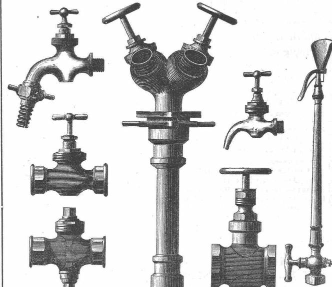
Wasserversorgungsartikel. — Hahnen etc. für Gasbeleuchtung.
