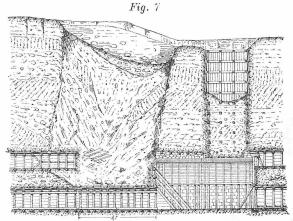
in die gemauerte Strecke hinein Schutt und Holztrümmer geworfen. Das Gewölbe hatte keine Beschädigung erlitten und die weitere Ausdehnung des Bruches gegen Westen ver-hindert. Der geringe Umfang des Trichters auf der Oberfläche des Berges zeigte, dass der Bruch mit nahezu senkrechter Begrenzungsfläche erfolgt war, so gross war aber die Heftigkeit gewesen, dass die Trümmer eines kleinen hölzernen Schuppens, der auf dem Berg über dem Tunnel gestanden, beim
