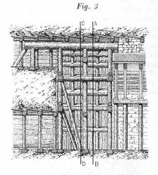
Hölzer waren neu, die Kronbalken 40 % stark und darüber, die Stempel von 30 % Durchmesser (s. Einbau Fig. 2 u. 3). Das Material des Ausbruchs bestand in Kies und grossen Findlingen, nach unten mit Lehm stark vermengt und so fest anstehend, dass in dem untern Theil des Widerlagers die Verpfählung überflüssig wurde und die Ausgrabung der Fundamente schwierig war.
