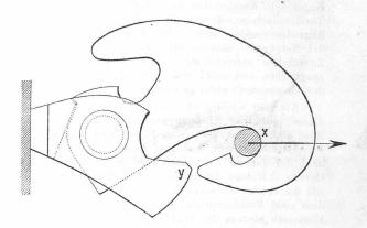
2. Der Haken dreht sich während die Spannung in der Reservekuppelung aufhört nach unten und dann öffnet sich die untere Hakenöffnung nach oben, so dass das Gewicht der Reservekuppelung den Bügel in dem Haken festhält. Bis zu der untersten Hakenstellung wirkt das Gewicht des Doppelhakens auch in diesem Sinne, dass der Kuppelungsbügel in die untere Hakenöffnung hineingedrückt wird.
