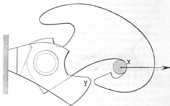
2. Der Haken dreht sich während die Spannung in der Reservekuppelung aufhört nach unten und dann öffnet sich die untere Hakenöffnung nach oben, so dass das Gewicht der Reservekuppelung den Bügel in dem Haken festhält. Bis zu der untersten Hakenstellung wirkt das Gewicht des Doppelhakens auch in diesem Sinne, dass der Kuppelungsbügel in die untere Hakenöffnung hineingedrückt wird.
