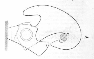
2. Der Haken dreht sich während die Spannung in der Reservehuppelung aufhört nach unten und dann öffnet sich die untere Hakenöffnung nach oben, so dass das Gewicht der Reservekuppelung den Bügel in dem Haken festhält. Bis zu der untersten Hakenstellung wirkt das Gewicht des Doppelhakens auch in diesem Sinne, dass der Kuppelungsbügel in die untere Hakenöffnung hineingedrückt wird.
