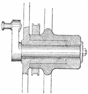
Die Kurbelwelle findet an diesem Zapfen ein Lager, und ist mit der Nabe des Schwungrades verkeilt. — Das Excenter für den Dampfschieber sitzt auf der Nabe des Letzteren. Die horizontal angeordneten Pumpen sind doppeltwirkend, die vertical angeordneten aber nur einfachwirkend.
