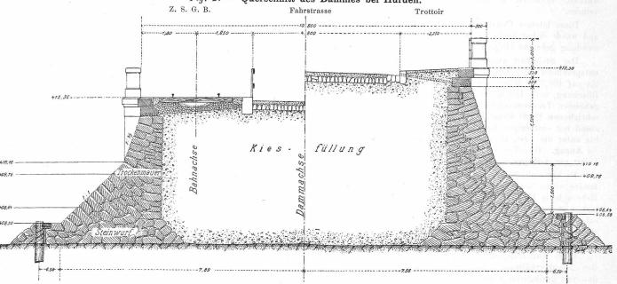
Fig. 3. — Normalprofil des mittleren Dammes.
