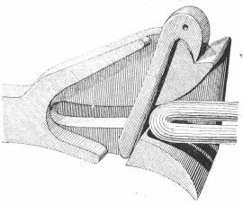
Bolzen ein Asbestseil, welches bis zur Wagendecke reicht, angebracht, ein Zug an diesem hebt den Bolzen genügend, um das Kettenglied zu befreien. Man kann desshalb die Wagen von oben, ohne zwischen dieselben zu treten, loskuppeln.
