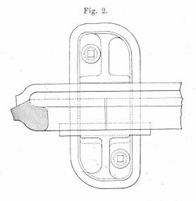
berühren, desshalb auch nicht beschädigt werden kann. Die Berührungsflächen der beiden Hälften liegen schief, so dass die eine die andere fest in den Stuhl einzwängt. Die Schienenstösse liegen in den Stühlen und sind bei beiden Hälften ver-
