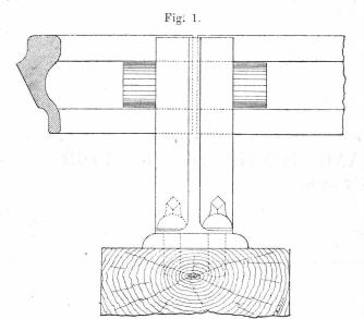
Wir illustriren dieselben, sowie deren Befestigungsart an den Stühlen und Schwellen in Fig. 1—3. Die vollständige Schiene besteht, wie aus dem Schnitt Fig. 3 ersichtlich ist, aus zwei ganz gleichen Hälften. Diese sind so zusammengestellt, dass der obere Theil der einen die Lauffläche, der untere Theil der andern die Leitkante bildet. Die Befestigung in den Stühlen geschieht mittelst hölzerner Keile, und es ist der Stuhl so eingerichtet, dass der untere Theil der Schienen denselben nicht
