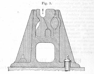
Seite als Lauffläche, die andere als Leitkante benutzen, man kann daher, wenn die eine Seite abgenutzt ist, die Schiene wenden und so vollständig ausnützen. Um eine solche Schiene auszuheben, hat man nur nöthig, zu beiden Seiten des Schienenstuhles je einen Stein aus dem Pflaster zu entfernen und den Holzkeil zu lösen. Es fällt daher das lästige Aufreissen der Strassen, bei allen, wenn auch den geringsten Reparaturen, weg.
