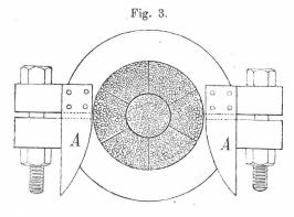
starken Hebeln zusammengepresst und verschraubt. Damit keine Drähte zwischen die Klammern schlüpfen können, sind am ren hölzernen Schlegeln und durch Nachhelfen mit Keilen wird dafür gesorgt, dass die Drähte alle ihre genaue Lage einnehmen und dass das Ganze zu einem soliden Körper sich verbindet. Hinter den Klammern wird der Kern sofort mit Draht umwunden, die Klammern weiter gerückt, und so schreitet dann die Arbeit fort.
