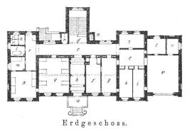
Höhe der Souterrainräume beträgt durchschnittlich 3,0 m/, die lichten Höhen des Erdgeschosses und der Etagen 3,9 m/.
