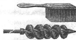
Gussputzbürsten von Stahldraht
