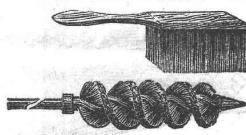
Gussputzbursten von Stahldraht
