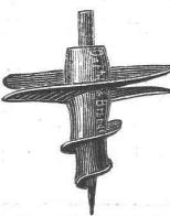
Bohlken's Patent-Erbohrer zum Verankern von Zelten, Brücken und Pontons, zum Setzen von Schanz-Telegraphen und Flaggen-Pfählen
