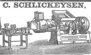
**C. SCHLICKEYSEN**, Maschinen-Fabrik Berlin S.O. Wassergasse 17.18, empfiehlt seine neuen transportablen liegenden Patent-Ziegel-, Röhren-, Dachziegel-, Lochziegel-, Platten-, Sims- etc. Pressen. Alle Sorten stets auf Lager.
