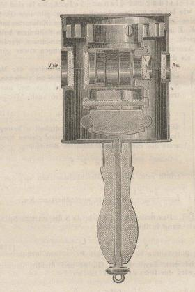
Damit für grössere Nivellements die Visirhöhe constant sei, kann man sich eines 1  $^{1/2}$   $^{m/}$  langen Stabes bedienen, auf den man das Instrument aufstellt und es soll die Lattentheilung bis auf eine Distanz von 60-80  $^{m/}$  auf 1  $^{c}$ /m genau abgelesen werden können. Man könnte also bei sehr günstigem Wetter zum Nivelliren aus der Mitte Stationen von 120-160  $^{m/}$  machen.
