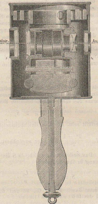
Damit für grössere Nivellements die Visirhöhe constant sei, kann man sich eines 1 1/2<sup>m</sup> langen Stabes bedienen, auf den man das Instrument aufstellt und es soll die Lattentheilung bis auf eine Distanz von 60—80<sup>m</sup> auf 1<sup>m</sup> genau abgelesen werden können. Man könnte also bei sehr günstigem Wetter zum Nivelliren aus der Mitte Stationen von 120—160<sup>m</sup> machen.
