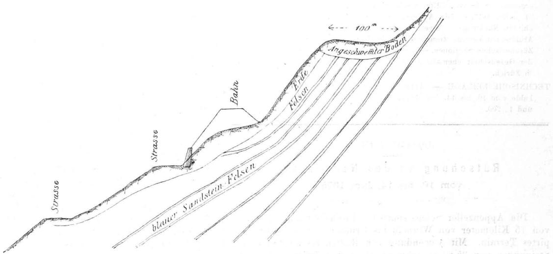
Die Felsschichten dürften zum Theil unter dem Damm auslaufen (der Felsen ist hart zum Sprengen, verwittert jedoch an der Luft äusserst rasch) und vermengen sich überdies mit den Nagelfluh- und Leberschichten aus dem Einschnitt (die Richtungen sind auf der Skizze angedeutet); auch scheint die erste Nagelfluhschicht mit eingebackenem grauem Sandstein die Schichten von der Plateaurichtung zu überlagern, welche dann auch die Bewegung mitmachen musste.
