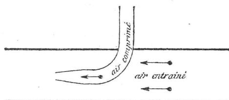
On peut combiner avec la ventilation un effet de refroidissement de l'air, en adoptant au centre du bec souffleur un tuyau de très-petit diamètre par lequel on injecte de l'eau. Cette eau, entraînée et pulvérisée par le jet d'air comprimé, se vaporise rapidement, en produisant un abaissement de température. (Voir figure 2).
