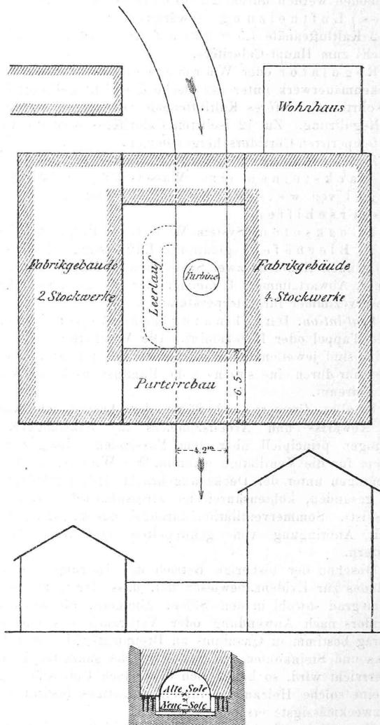
Bei Gelegenheit der Ausführung dieser Turbinenanlage sollte gleichzeitig das nutzbare Canalgefälle von circa 2 auf 2 1/2 Meter gebracht werden. Der Boden der Turbinenkammer selbst war
