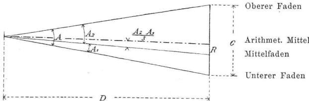
Aus denselben Werthen lässt sich auch die dritte zur Berechnung nothwendige Constante ableiten, nämlich der Winkelwerth zwischen dem Mittelfaden und dem arithmetischen Mittel der drei Fäden.
