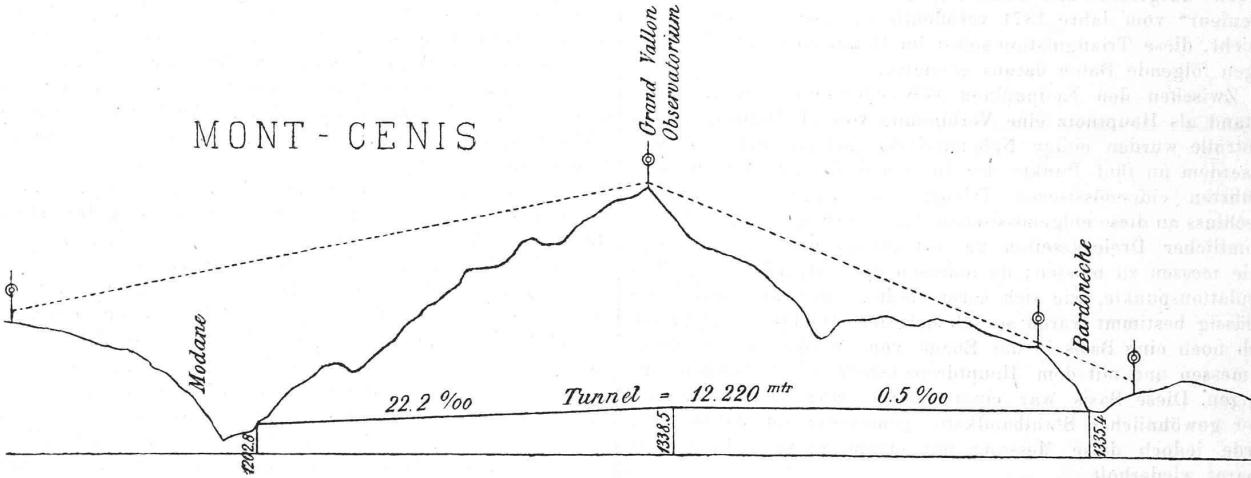
Es wurden hier zuerst versuchsweise über das Bergmassiv, das der Tunnel zu durchfahren hatte, einige Linien abgesteckt, bis man eine erhielt, welche ungefähr durch die beiden projectirten Tunnelmündungsstellen ging. Diese provisorische Richtung benutzte man, um auf dem höchsten Punkt, dem Grand-Vallon, ein Observatorium zu errichten und von ihm aus mittelst eines grössern Theodoliten zu beiden Seiten rückwärts der Mündungen Punkte zu bestimmen. Waren diese
