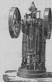
La machine est montée sur un bâti isolateur qui est porté sur le socle et n'occasionne aucune trépidation à la chaudière. Une détente circulaire, mise en mouvement par le régulateur, assure une parfaite régularité de marche cherchée jusqu'ici sans résultat satisfaisant, et donne une économie de combustible d'au moins 15 %.
