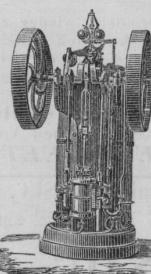
La machine est montée sur un bâti isolateur qui est porté sur le socle et n'occasionne aucune répétition à la chaudière. Une détente circulaire, mise en mouvement par le régulateur, assure une parfaite régularité de marche cherchée jusqu'ici sans résultat satisfaisant, et donne une économie de combustible d'au moins 15 %.
