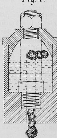
Fig. 1 und 2 zeigt eine der gebräuchlichsten Constructionen der Schmiergefässer, welche aber folgende Nachtheile an sich trägt:
