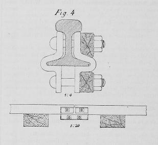
von weniger Bedeutung, denn sie ist nicht so sehr beansprucht wie die Schiene, bricht nicht so leicht und wenn sie bricht, so kostet ihre Ersetzung weniger als die der Schiene. Die Klinkung erfüllt ihren Zweck, die Schiene an Längsverschiebungen zu verhindern, ebenso so gut, als ob sie im Schienenfuss angebracht wäre. Dem schädlichen Losrütteln der Laschenbolzen begegnet man, wie Fig. 4 (einer sehr practischen Laschenverbindung für schwebenden Stoss) andeutet, durch zwischen
