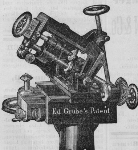
Diese Maschine löst die bisher so schwierige Aufgabe, conische Räder zu fraisen, vollkommen, indem es bis dahin noch nicht gelungen war, dieselben auf eine rasche und genaue Weise herzustellen. In der vorliegenden Maschine ist besonders auf einfache Construction Bedacht genommen, so dass jeder Arbeiter im Stande ist, dieselbe leicht zu bedienen.
