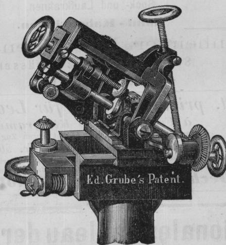
Diese Maschine löst die bisher so schwierige Aufgabe, conische Räder zu fräsen, vollkommen, indem es bis dahin noch nicht gelungen war, dieselben auf eine rasche und genaue Weise herzustellen. In der vorliegenden Maschine ist besonders auf einfache Construction Bedacht genommen, so dass jeder Arbeiter im Stande ist, dieselbe leicht zu bedienen.
