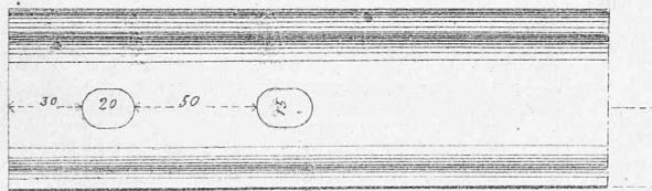
Länge der Schiene 5.0 m Gw: pr. lf. Mel. 10.18 Kil.
