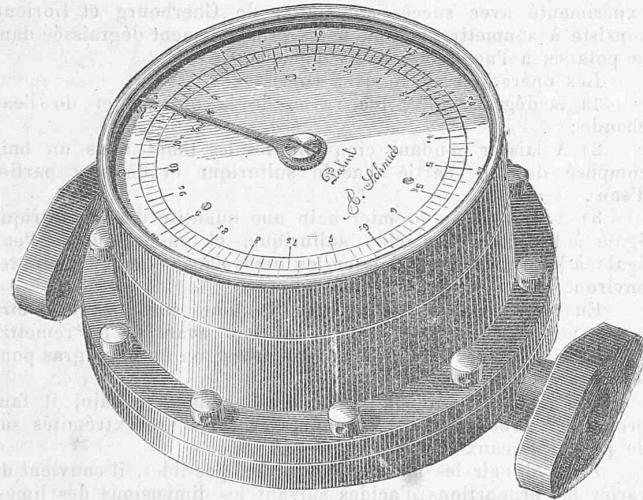
Dieser Flüssigkeitsmesser besteht im Wesentlichen aus zwei unter einem rechten Winkel zusammengekuppelten hydraulischen Maschinen, bekannt unter dem Namen „Schmidt's Wassermotoren“, welche in einem wasserdichten Gehäuse eingeschlossen, von der zu messenden, unter einem gewissen Drucke befindlichen Flüssigkeit in Bewegung gesetzt werden.
