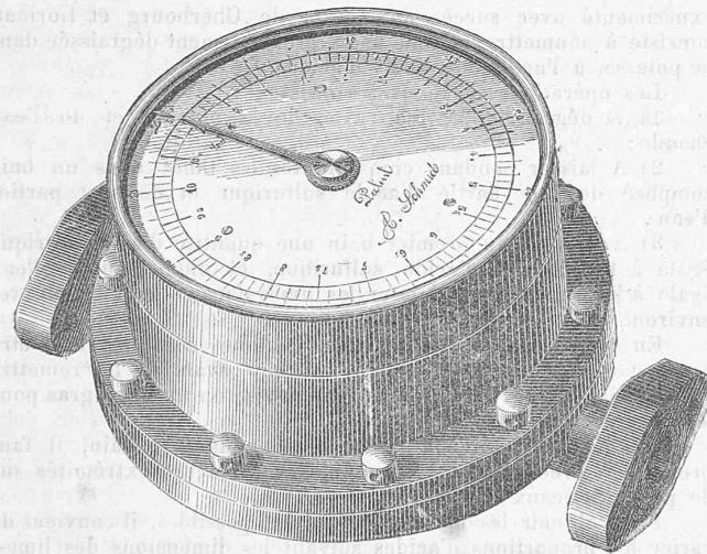
Dieser Flüssigkeitsmesser besteht im Wesentlichen aus zwei unter einem rechten Winkel zusammengekuppelten hydraulischen Maschinen, bekannt unter dem Namen „Schmidt's Wassermotoren“, welche in einem wasserdichten Gehäuse eingeschlossen, von der zu messenden, unter einem gewissen Druck befindlichen Flüssigkeit in Bewegung gesetzt werden.
