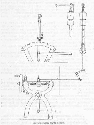
Die Dienstausführung des Locomotivführers verlangt nach den jetzigen Einrichtungen Zeit, derselbe muss 1) den Dampf abschliessen, 2) den Steuerungshebel zurücklegen, 3) den Dampf
