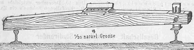
Die Eisenbahnwasserwage ist in einem hölzernen Lineal von 1740 m gefasst, dasselbe ist an den beiden Auflageflächen mit eisernen Schienen versehen, die verstellbare Zunge ist in Doppel-Millimètres und Linien eingetheilt und kann 150 m/m ausgezogen werden. Eine Schraube mit bequemer, starker Flügelmutter (aus Rothguss) erlaubt die Feststellung der Zunge.
