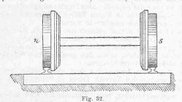
gleichläufig sind, die Räder zu Polen ein und desselben Magnetes werden, im Augenblicke wenn der electrische Strom durch dieselben geleitet wird. Die Erfahrungen eines mehr als ein-jährigen Betriebes zeigten, dass sich die Adhäsion der Räder um mehr als 40 % durch den Magnetismus vermehren liess.
