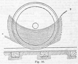
Auf sehr schlüpfrigen Schienen schleuderten im unmagnetisirten Zustande die Räder bei 19 Pfd. Dampfdruck, im magnetisirten Zustande aber erst bei 35 Pfd.
