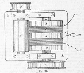
zwei auf Messinghülsen c aufgerollte Drahtspiralen gelagert und durch Füsse i mit dem Gestell verbunden, sodass sich die Achse frei in den Spiralen, welche fix sind, bewegen können. Wird nun ein electrischer Strom durch die Spiralen geleitet, so werden die Scheiben a magnetisch, und ohne irgend welche
