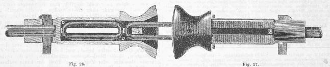
Fig. 24 ist ein Längeschnitt, Fig. 25 eine Seitenansicht, Fig. 26 ein horizontaler Schnitt, Fig. 27 die Ansicht von oben. A in Fig. 24 ist ein automatischer Haken oder Klinke, der durch den Ring C aufwärts gedrückt wird, wenn dieser darunter durch geht, dann aber herunterklappt und in der Lage, wie in Fig. 24 gezeichnet, die Wagen kuppelt. E ist ein Reservering, in der
