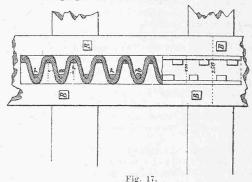
Eine weitere Neuerung besteht darin, dass nicht mehr zwei Motoren gebraucht werden, sondern nur noch einer am Fusse der schiefen Ebene. Von diesem Motor gehen zwei Seile aufwärts, legen sich, oben angekommen, um zwei Leitrollen und kehren dann direct zum Ausgangspunkt zurück, wo sie zweimal um die Triebrollen laufen und dann zum Dynamometer gehen. Die Rollen liegen auf den geraden Strecken 15 m. auseinander, in Curven 3.00 m.
