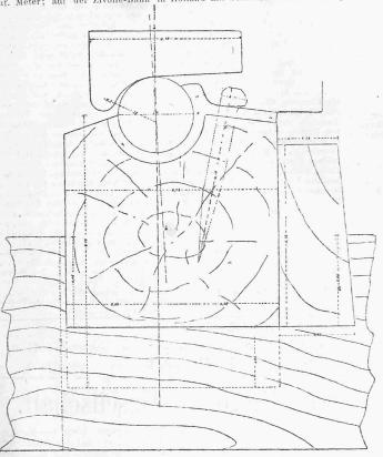
Durchschnitt durch die Mitte einer Längsschwelle. Fig. 19.
