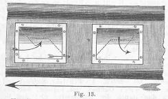
Diese Ventilatoren werden am Dache des Wagens angebracht, wie Fig. 12 und 13 zeigen und zwar so, dass nach aussen
